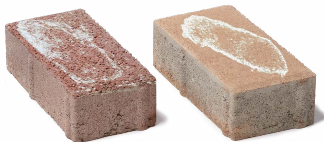
Dlažba s výkvětem
