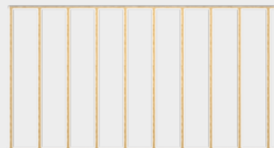
Osová vzdálenost spodní konstrukce max. 500 mm
