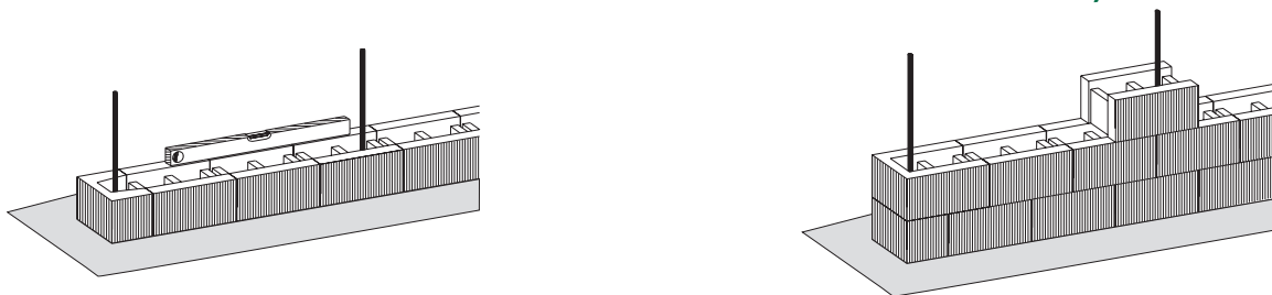
osazení jednotlivých řad tvarovek na betonový základový pás; svislé proarmování; následné vyplnění tvarovek betonem v celé výšce zdi
