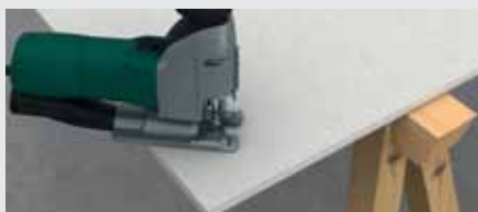
Řezání elektrickou přímočarou pilou
