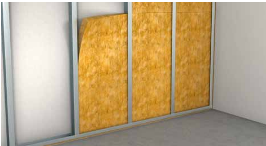
Vkládání izolačních desek z minerálních vláken
