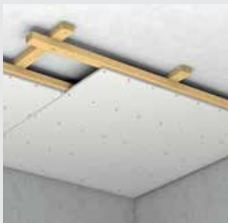
Přímo kotvený obklad s dřevěnou spodní konstrukcí
