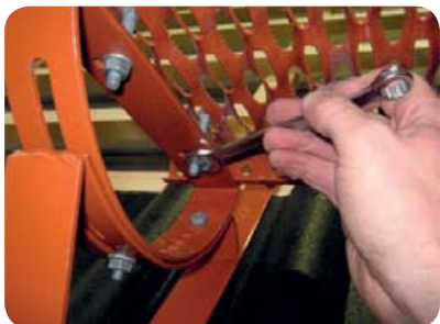
Obr. 6 Připevnění stoupací lávky
