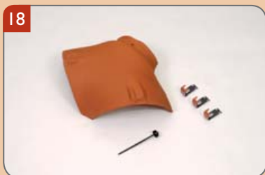
Rozdělovací hřebenáč malý kónický HO s třemi příchýtkami hřebenáče HO + N a s jedním hřebem Pro spojení hřebene a dvou nároží do malty.
