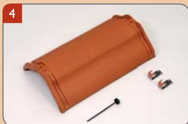
4 Hřebenáč vyrovnávací bez hrdla drážkový HO s dvěma příchytkami hřebenáče HO + N a s jedním hřebem Pro napojení na rozdělovací hřebenáč a k vyrovnání délky hřebene.
