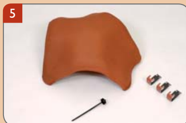
5 Rozdělovací hřebenáč drážkový HO s třemi příchytkami hřebenáče HO+N a s jedním hřebem Pro napojení hřebene a dvou nároží. Pro sklony střech 15° až 55°.
