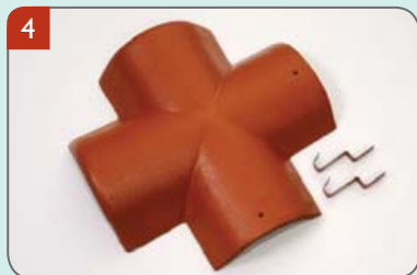
Rozdělovací hřebenáč X se dvěma příchytkami Pro kolmé napojení dvou protínajících se hřebenů v jedné rovině.
